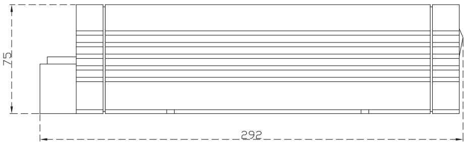
Afbeelding 4 WSC-1250 / WSC-2425 lader zij aanzicht (mm)
